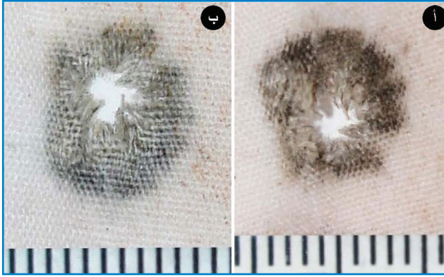
(الشكل 5-16): مسحة مقذوف نموذجية في طبقة من القماش الرقيق نتيجة مرور مقذوف من إطلاق بعيد (أ) السطح الخارجي، (ب) السطح الداخلي.
