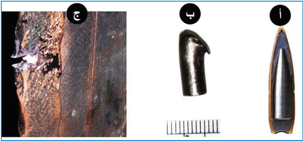
(الشكل 12-4): المقذوفات المختركة للدروع: (أ) مقطع يوضح كيفية وجود اللب المصنوع من الصلب داخل المقذوف؛ (ب) لب المقذوف بعد اختراقه لحافة سميكة لباب معدني، ويلاحظ تشوه مقدمته المقذوف، وخطو جسمه من علامات الششخنة.
