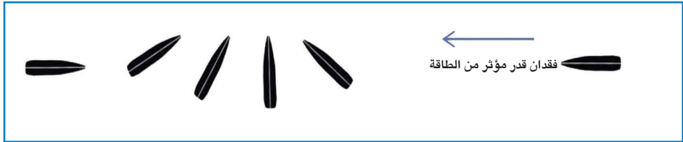
(الشكل 2-4): تصور لتوضيح فقدان ثبات المقذوف في مساره وتذبذبه نتيجة فقدان قدر كبير من طاقته مما يؤدي لارتطم المقذوف بالجلد بجزء آخر غير المقدمة.
