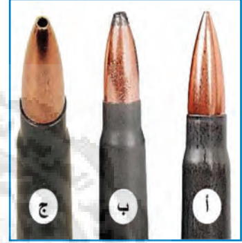
(الشكل 4-18): نموذج لمقدمة المقذوفات 39x7.72 ملي متر المستخدم في البندقية الكلاشنكوف (AK-47): (أ) للاستخدام العسكري؛ (ب، ج) للاستخدام المدني.
