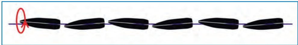
(الشكل 4-1): تصور مبسط لتوضيح تذبذب المقذوف في مساره في الهواء (Yaw).
